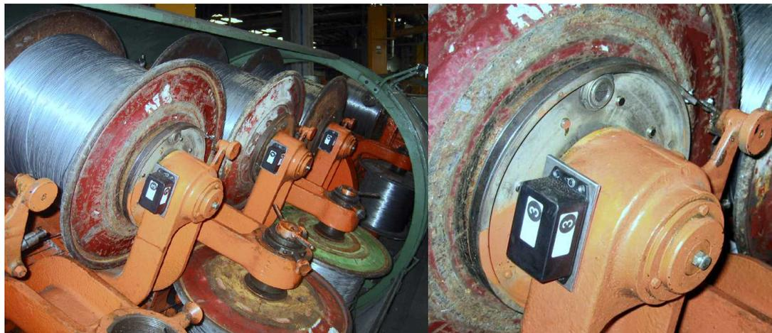
I tradizionali rilevatori di rottura filo basati sul controllo di rotazione della bobina non si possono installare nelle macchine sprovviste di collettori a contatti striscianti.
